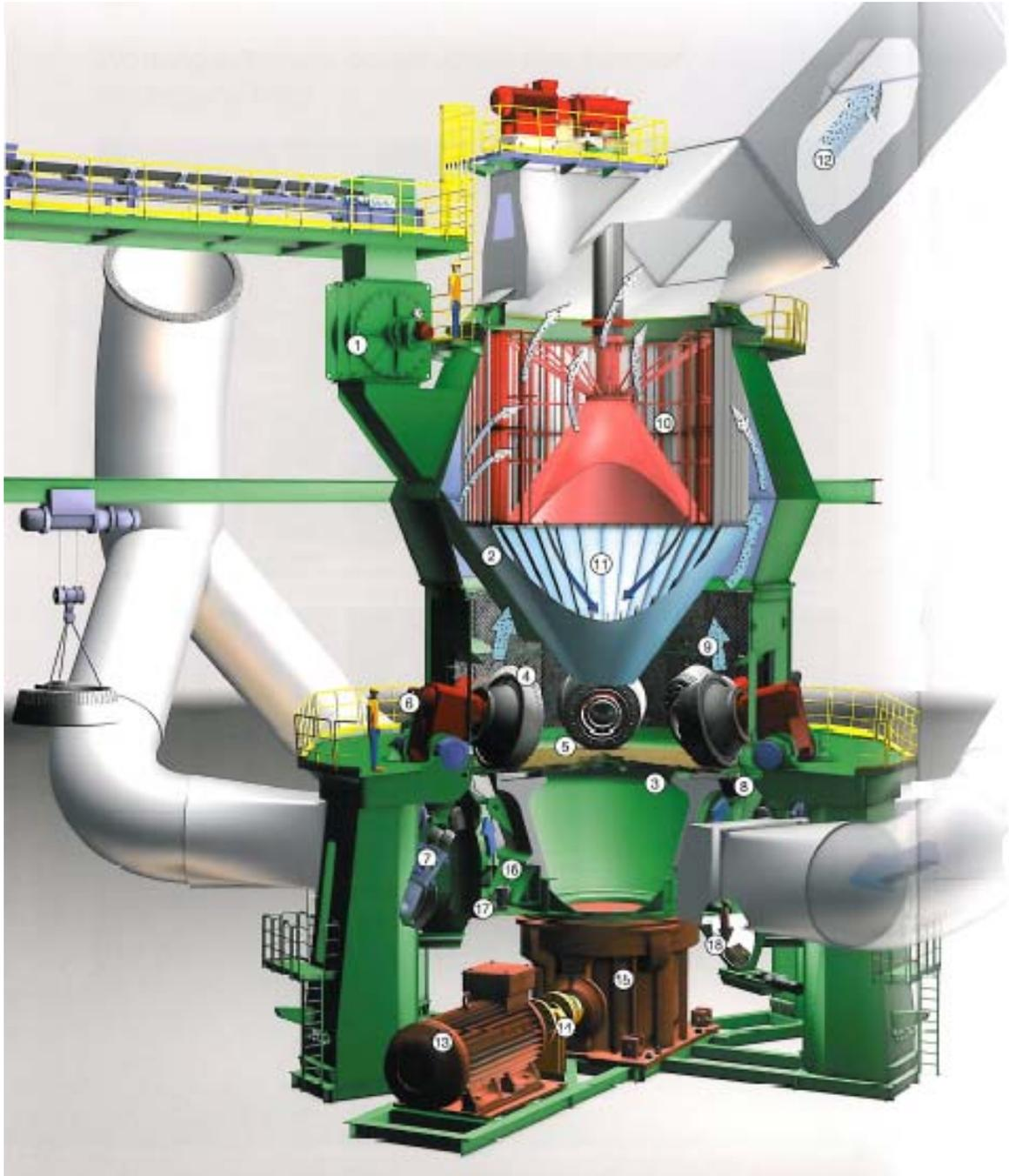
L'effetto di macinazione è assicurato dall'azione combinata della pressione esercitata sul materiale da macinare dai rulli macinatori contro la pista di macinazione rotante, azionata da idoneo motore e riduttore meccanico. Un sofisticato sistema di pressurizzazione dell'olio idraulico (centralina idraulica)
